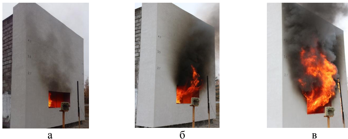
Рисунок 2 - Высота пламени, которое выходит из оконного проема при внутреннем пожаре, на моменты времени от начала: а - 1 мин; б - 10 мин; в - 25 мин
