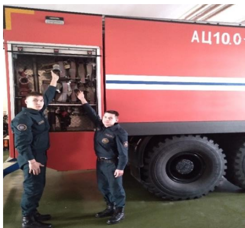
Сурет – Биіктігі 165 және 195 см өрт сөндіру бөлігінің жоғарғы сөресінен өрт сөндіру жандарын алу мүмкіндігінің салыстырмалы сипаттамасы
