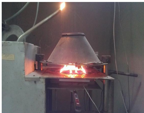
Рисунок 2 – Общий вид испытаний на теплостойкости
