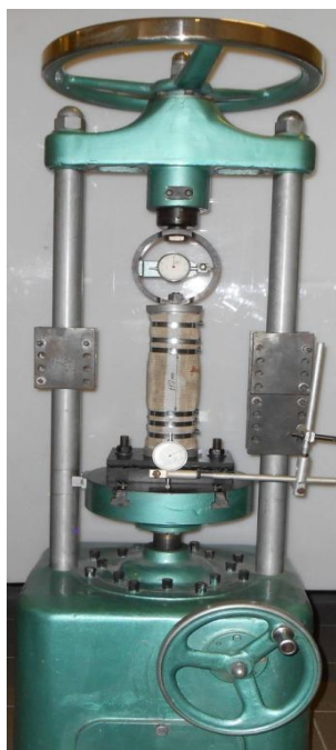
Рисунок 1 – Опытная машина ДМ-30М с установленным образцом рукава
