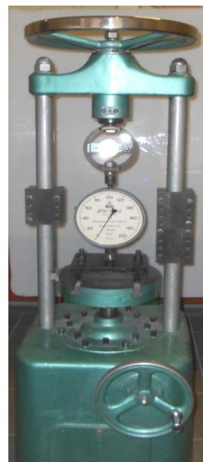
Рисунок 2 – Опытная машина с тарировочным устройством
