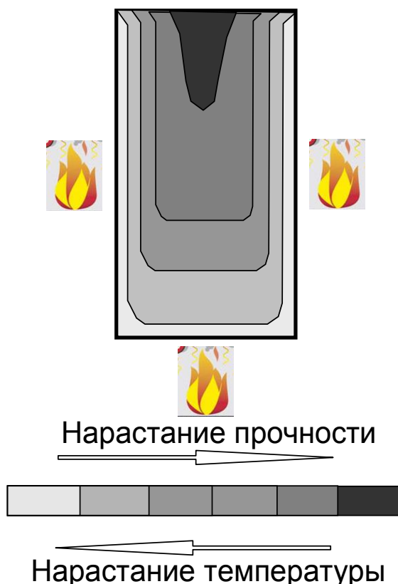
Рисунок 1 - Изменение прочности в сечении балки в зависимости от температуры
