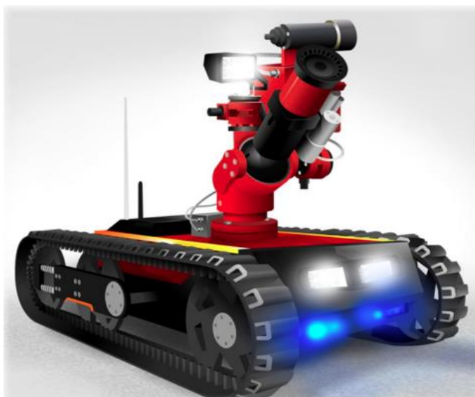
Рисунок 1 - Робототехническое средство предназначено для разведки на месте пожара, мониторинга обстановки и выполнения действий по тушению пожаров.
