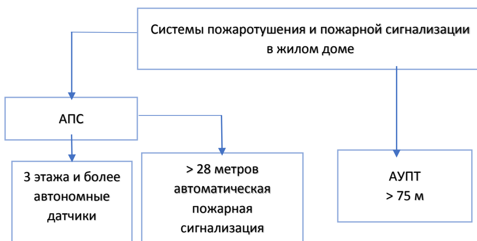
Рисунок 1 - Оснащение жилых зданий автоматическими установками пожаротушения и пожарной сигнализации
