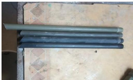
Рисунок 4 – Трубки, извлеченные из огнетушителя ОП4 одного производителя при перезарядке
