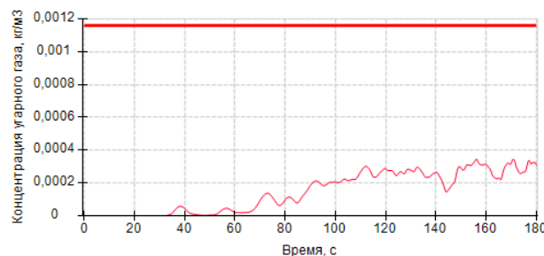
Рисунок 4 – Изменение содержания концентрации угарного газа во времени
