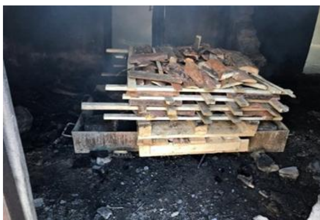
Рисунок 1 - Подготовка к проведению натурных огневых испытаний. Модельный очаг
