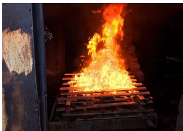
Рисунок 2 - Горение модельного очага
