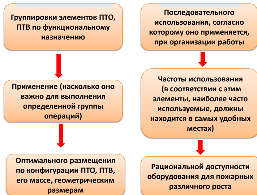
Рисунок 30. Принцип размещения инструмента и оборудования на пожарных автомобилях.
