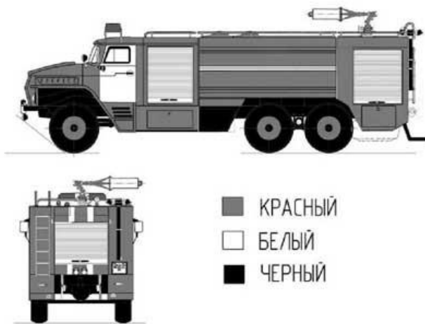
Рисунок 44. Цветовое изображение кузовных элементов автоцистерны
