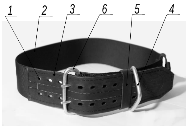
Рисунок 11. Пояс пожарный спасательный 1 – люверсы; 2 – поясной ремень (лента); 3 – кожаная облицовка; 4 – карабидержатель; 5 – хомутик; 6 – пряжка
