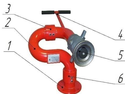
Рисунок 27. Стационарный лафетный ствол: 1- основание; 2 – колено; 3 – шарнир для наведения в вертикальной плоскости; 4 – ручка для управления; 5 – насадок с возможностью регулирования угла факела распыла; 6 – шарнир для наведения в горизонтальной плоскости.
