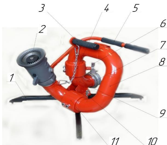
Рисунок 28. Переносной лафетный ствол ЛС-П20У: 1 – опора; 2 – насадок с возможностью регулировки угла факела распыла; 3 – ручка для переноски; 4 – шарнир для поворота в горизонтальной плоскости; 5 – ручка для управления; 6 – фиксатор; 7 – гайка пожарная соединительная; 8 – колено; 9 – основание; 10 – фиксатор; 11 – шарнир для наведения в вертикальной плоскости.
