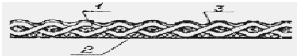
Сурет 41. Латекстелген жеңнің схемасы.
