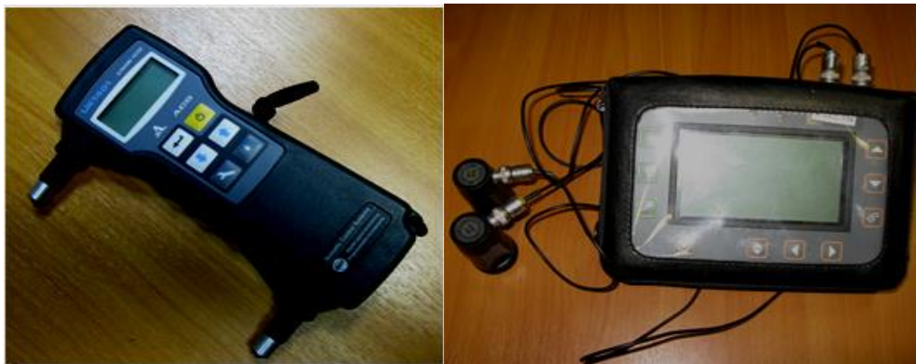
Рисунок 4.2. Ультразвуковые дефектоскопы а - с зафиксированными датчиками измерения; б - дефектоскоп с расстоянием между датчиками
