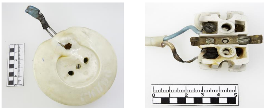
Рисунок 6.5 Коммутационные изделия со следами БПС
