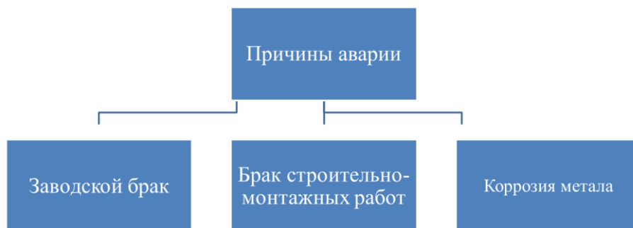
Рисунок 10.3. – Основные причины аварии на газопроводах
