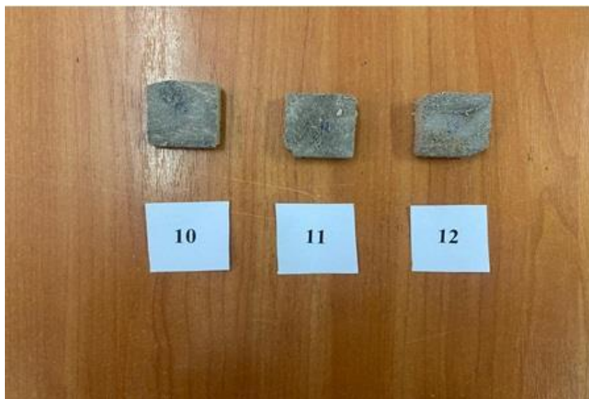
Рисунок 1 - Образец древесины сосны обработанный огнезащитным составом
