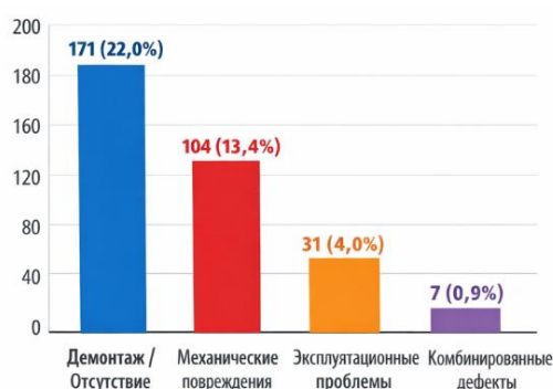
Рисунок 2 - Группировка дефектов пожарных гидрантов по характеру неисправностей
