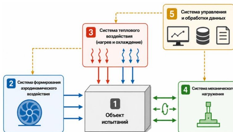
Рисунок 1 – Схема реализации способа проведения комплексных аэродинамических, тепловых и тепломеханических испытаний
