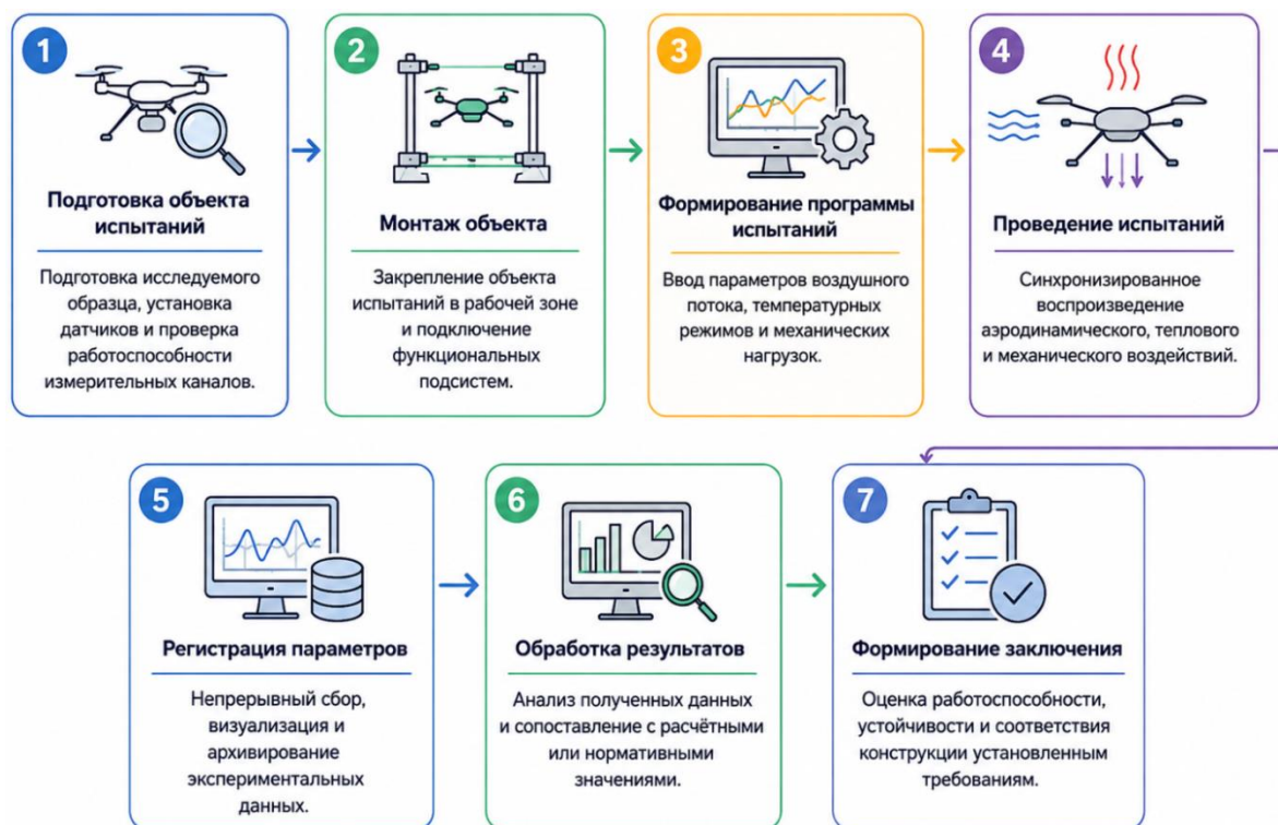
Рисунок 2 – Последовательность проведения комплексных испытаний
