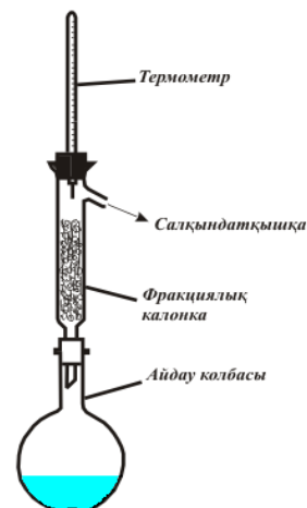
Сурет 7. Фракциялық колонка жалғанған айдау колбасы.
