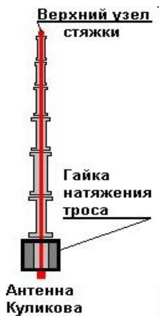
Рис. 19. Конструкция антенны Куликова.
