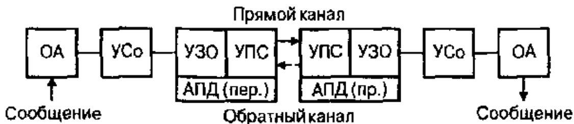
Рис. 12. Структурная схема системы передачи данных
