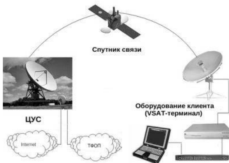
Рисунок 30 - Спутниковая связь VSAT
