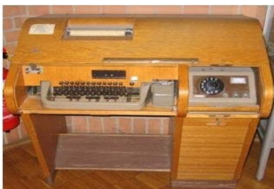
Рисунок 7 - Оборудование "Телекс Т100" немецкой компании Siemens
