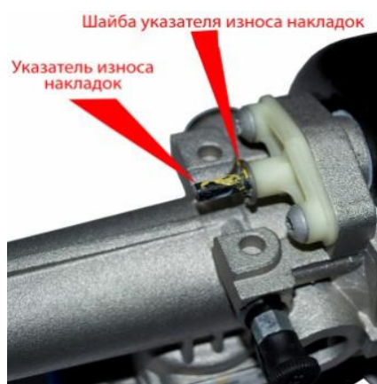
Рисунок 2.10 – Указатель уровня износа накладок ПГУ WABCO
