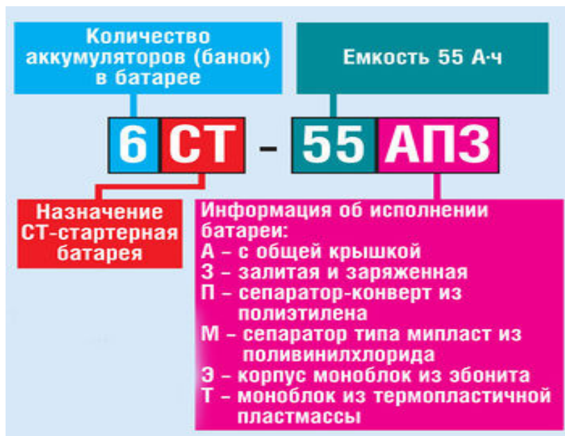
Рисунок 2.75 – Отечественное обозначение аккумуляторной батареи
