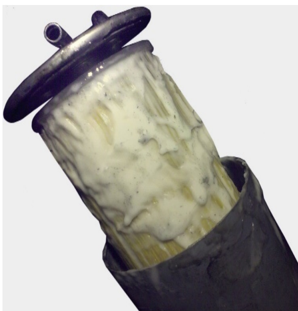
Рисунок 1.31 – Выпадение кристаллов парафина в фильтре тонкой очистки топлива
