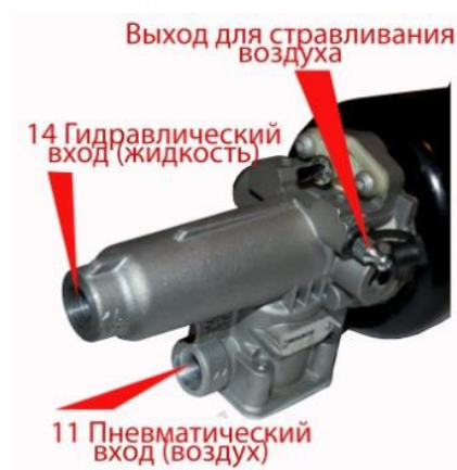
Рисунок 2.10 – Указатель уровня износа накладок ПГУ WABCO
