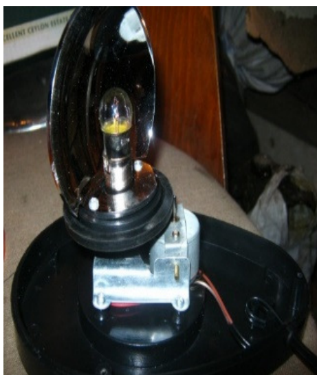
Рисунок 2.92 – Проблесковый маяк: устройство
