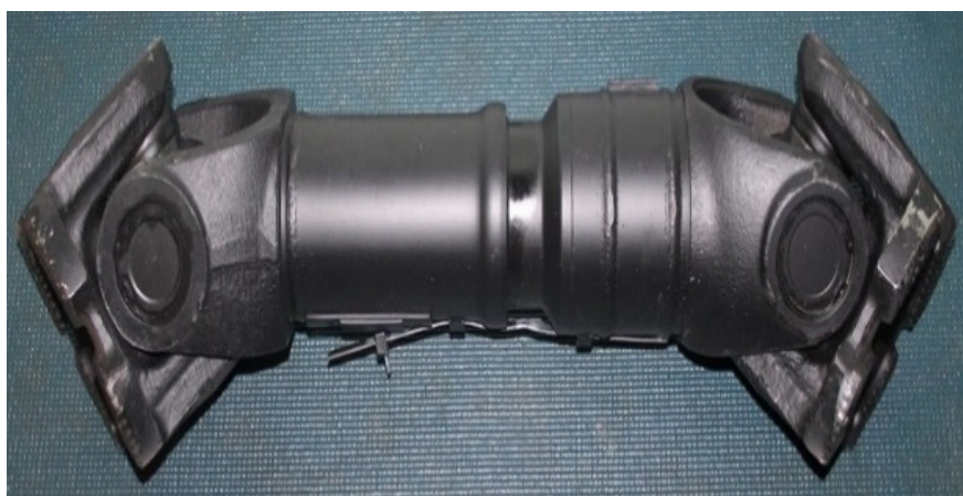
Рисунок 2.19 – Карданный вал: общий вид
