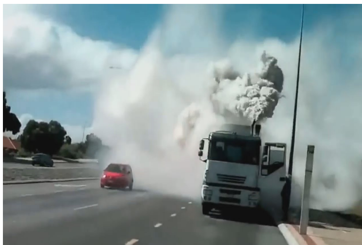
Рисунок 1.32 - Разнос дизельного двигателя
