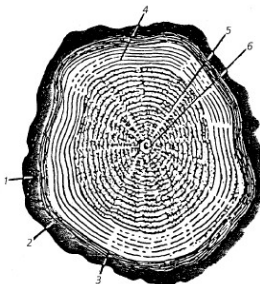
Сур. 4.3. Көлденең кесiндiдегi ағаш дiңгегiнiң құрылысы: 1 – сыртқы қабық; 2 – ішкі қабық; 3 – камбий қабаты; 4 – жылдық сақиналар; 5 – ядро; 6 – өзек
