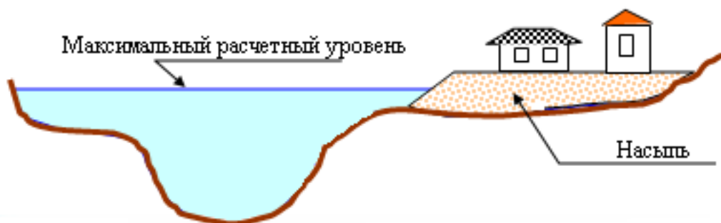
Рисунок 37 -Схема повышения уровня земли
