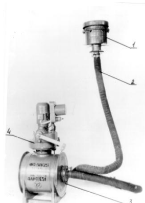
Рис. 2.16. Фильтровентиляционный агрегат ФВА-50/25:
