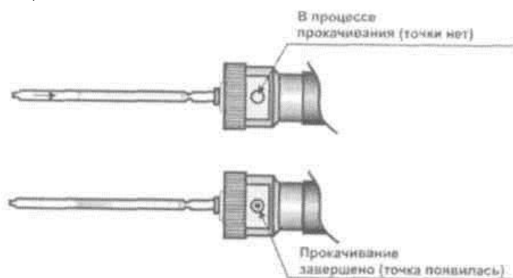
Рис. 5.11. Работа сигнального устройства насоса-пробоотборника НП-3М
