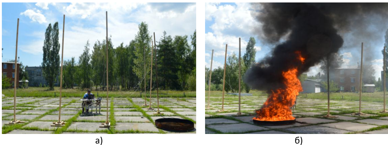
Рисунок 1 - Фото экспериментальных исследований: а) расположение модельного очага пожара и исследуемых образцов перед проведением экспериментальных исследований, б) фрагмент проведения экспериментального исследования
