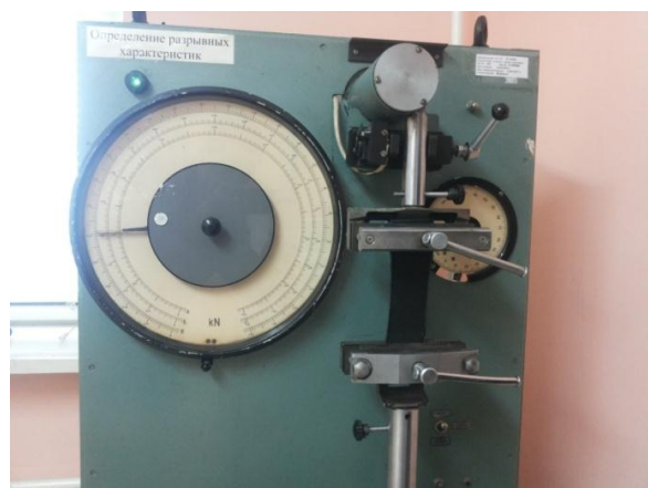
Рисунок 3 – Определение устойчивости материала верха БОП к разрывной нагрузке
