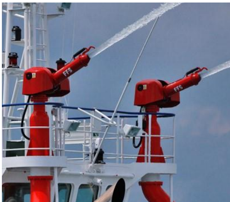
Рисунок 2 - Стационарный судовой лафетный ствол модели «FFS 1200/300 - Long Barrel» многоствольного модуля пожаротушения танкерного судна с системой дистанционного управления
