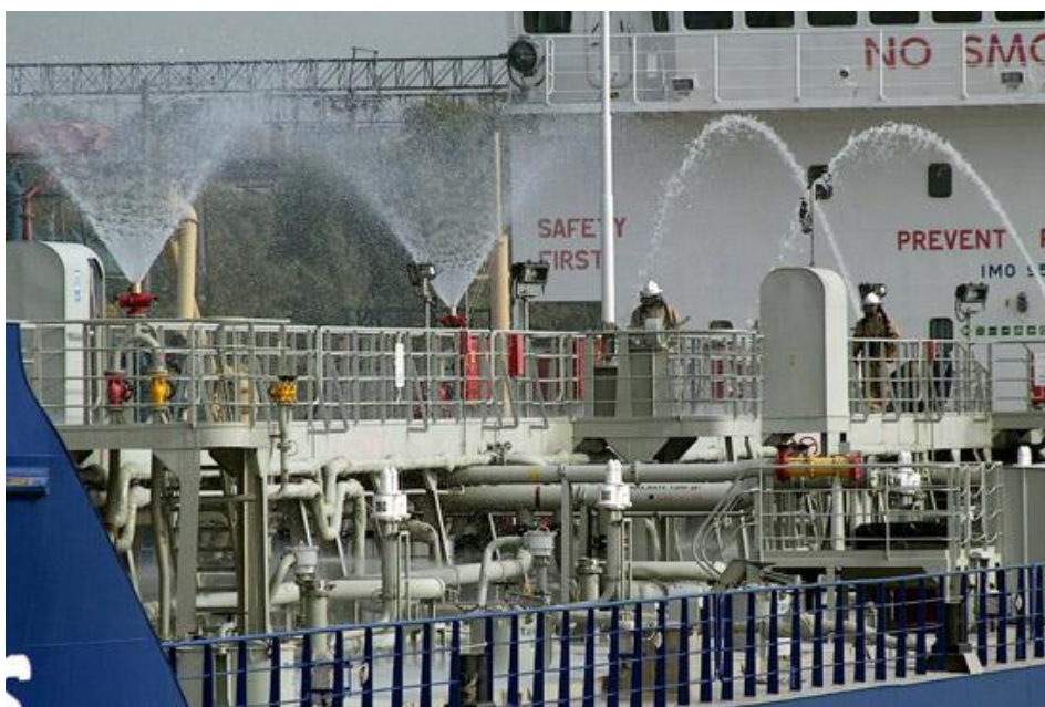
Рисунок 1 - Автоматическая многоствольная модульная система пожаротушения танкерного судна
