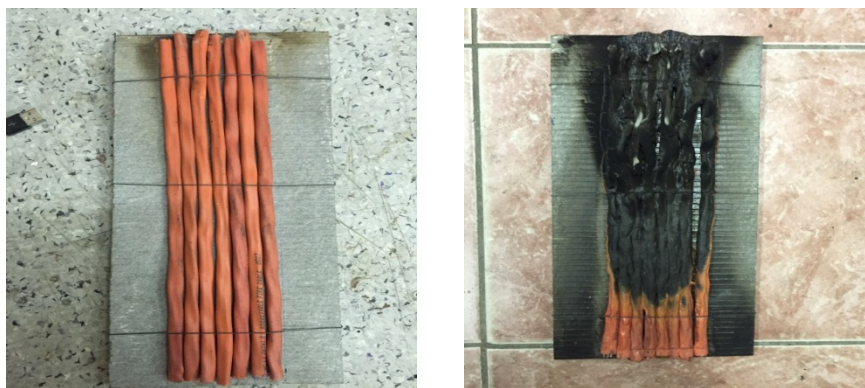
Рисунок 6 - Образец с кабелем КМВВ – П-нг LS 2x2x1.5до и после испытания
