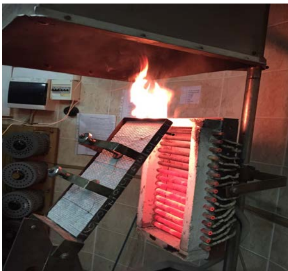
Рисунок 10 - Испытания кабеля КМВЭВ на установке ИРП
