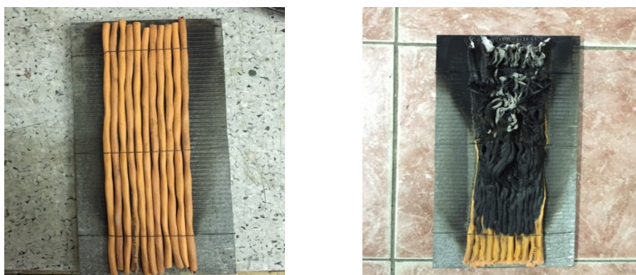
Рисунок 7 - Образец с кабелем КМВВнг LS 1x2x1.5до и после испытания
