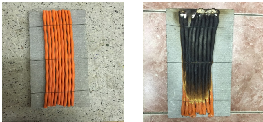
Рисунок 8 - Образец с кабелем КМЖ НГ – LSFRHF 1x2x1.5 до и после испытания
