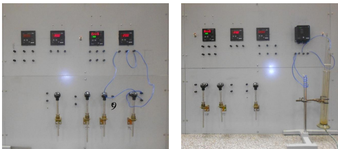
Рисунок 2 - Лабораторные стенды по изучению ТРМ1, 2ТРМ0, ТРМ202, терморезисторов и термопар
