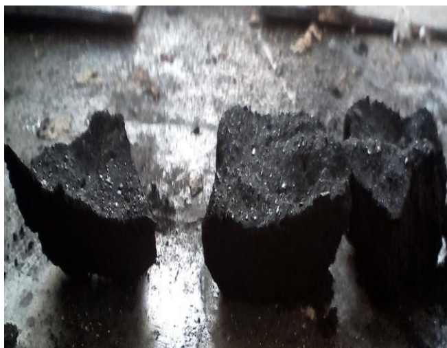
Рисунок 3 – Поверхностный слой угольных частиц, связанных между собой составом для обеспыливания (проникновение состава на глубину до 30 мм)
