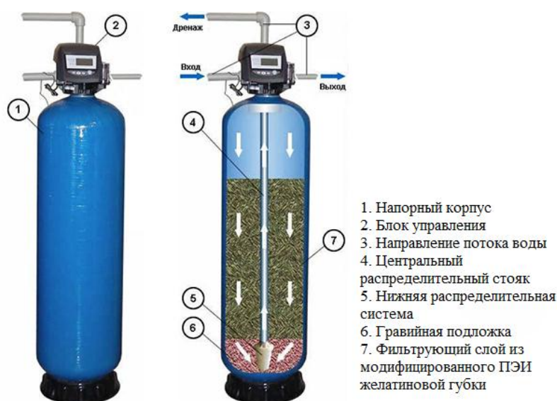
Рисунок 7 - Проект автоматической системы очистки воды от ионов свинца
