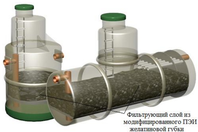
Рисунок 8 - Сорбционный блок очистки сточных вод от свинца
