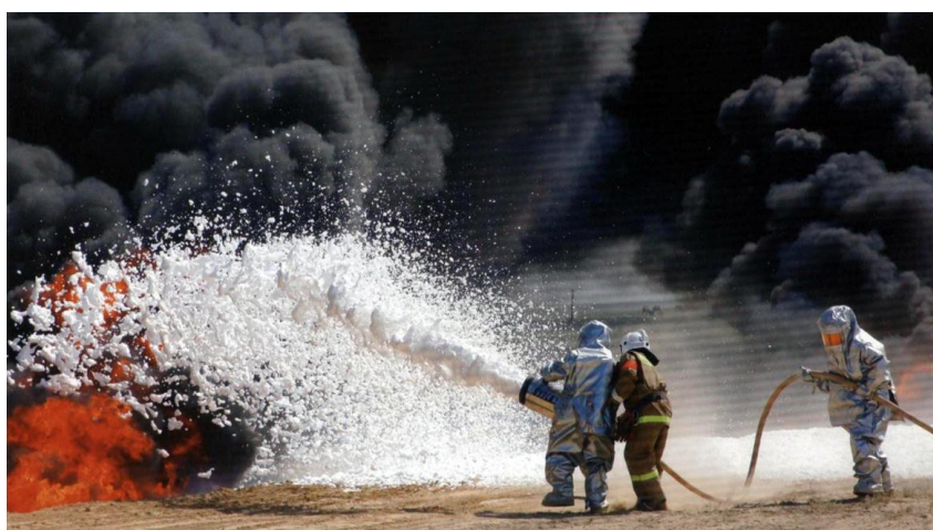
Рисунок 3 - Тушение горящего нефтепродукта установками пенного пожаротушения типа «Пурга» во время крупномасштабных огневых исследований пожара разлива нефтепродуктов на полигонах в г. Атырау и г. Актау
