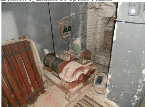
Рисунок 3 – Внешний вид э/лебедки с оголенными контактами
